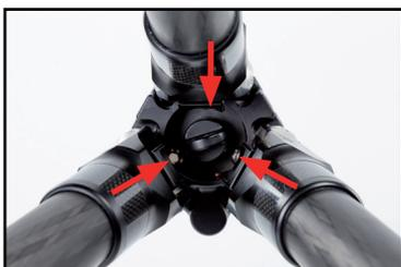
In der Stativschulter sind 3 Madenschrauben eingebaut. Diese werden von unten mit dem beigegefügteten Inbusschlüssel bedient. Nach dem Aufsetzen eines Kugelkopfs oder Nivellierhilfe (z.B. LB-15) werden die Madenschrauben angezogen. Damit ist der Kugelkopf etc. auf der Schulter gesichert. Zum Abschrauben des Kugelkopfes erst die Madenschrauben lösen.
