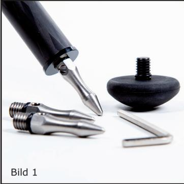
Das Wechseln zwischen gehärteter Stahlspitze und GummifuÙ geht bei den FLM-Stativen sehr einfach, schnell und problemlos von statten. Das Ende des untersten Carbon-Rohres ist mit einem Aluminiumeinsatz versehen. Dieser ist mit einem 3/8-Zoll Innengewinde versehen. Es können nun wahlweise die GummifuÙe oder die Spikes eingeschraubt werden. Für die Spikes kann als Montagehilfe der beiliegende Inbusschlüssel zum Einsatz kommen. (Bild 1).
