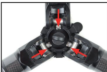
In der Stativschulter sind 3 Madenschrauben eingebaut. Diese werden von unten mit dem beigegefügt Inbusschlüssel bedient. Nach dem Aufsetzen eines Kugelkopfs oder Nivellierhilfe (z.B. LB-15) werden die Madenschrauben angezogen. Damit ist der Kugelkopf etc. auf der Schulter gesichert. Zum Abschrauben des Kugelkopfes erst die Madenschrauben lösen.
