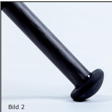
Achten Sie beim Wechseln der FüÙe bitte auf Sauberkeit. Selbst kleinste Partikel wie Sandkörner können sonst das Gewinde des Aluminiumeinsatzes schädigen, so dass bei der erneuten Montage der FüÙe das Gewinde zu klemmen beginnt. Die Folge ist, dass die FüÙe sich nicht mehr sauber ein- und ausschrauben lassen. Siehe dazu auch das Kapitel „Reinigung & Pflege“.
