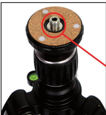
Der Kamera-Teller ist mit einer 3/8"-Aufnahme ausgestattet zur Aufnahme von Zubehör mit entsprechendem Gewinde im Boden, wie z.B. Schnellwechsel-Basen oder Panoramawinkel usw. Für die Montage der Kamera direkt mit der Montageplatte des Stativs, liegt eine 1/4"-Schraube und das benötigte Werkzeug zum Tauschen bei.
