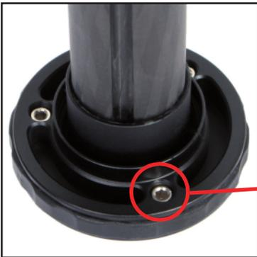
Vor der Demontage des Stativkopfs müssen zunächst die drei Gewindestifte wieder geöffnet werden. Dazu diese mit Hilfe des Innensechskantschlüssels nach links drehen, bis der Stativkopf frei drehbar ist. Erst dann den Stativkopf vom Stativ abschrauben.
