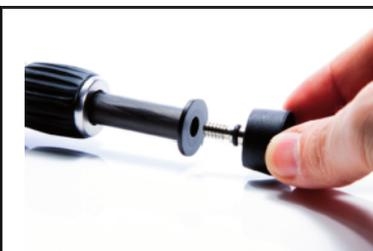
Nach dem Einsatz der Spikes, müssen diese ebenfalls vor dem Wiederaufsetzen der Gummifüße gründlich gereinigt werden. Befinden sich z.B. noch Sandpartikel in den Gewindegängen, kann beim Aufdrehen der Gummifüße das Gewinde am Spike oder im Gummifuß irreparabel geschädigt werden. Das Gewinde am Spike und im Gummifuß leicht fetten.
